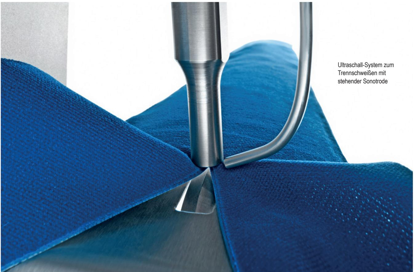
Ultraschall-System zum Trennschweißen mit stehender Sonotrode
