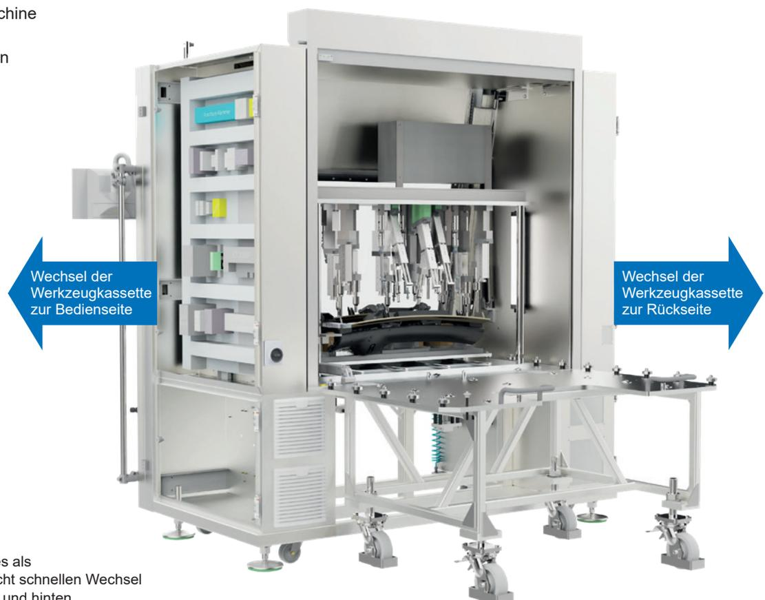
Gestaltung des Werkraumes als Werkzeugkassette ermöglicht schnellen Wechsel der Werkzeuge nach vorne und hinten.
