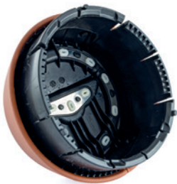
Ultraschall-Nieten von Airbagkappen
