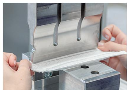
3. Horizontale Ultraschall-Schweißung der Quernähte 1 und 2. Das Nasenklemmband wird manuell eingeschoben (ohne Bild).
