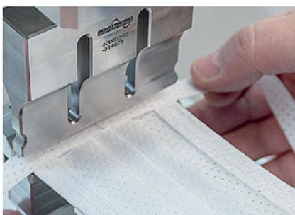
4. Vlies-Flachbänder, die zur Befestigung am Kopf dienen, auf der kurzen Seite auflegen.
