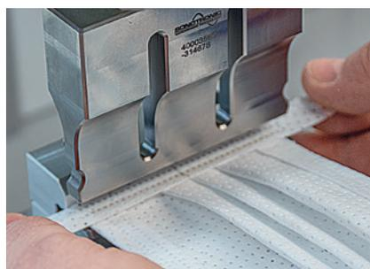
5. Vertikale Ultraschall-Schweißung der Seitennähte 3 und 4 fixiert die Vlies-Flachbänder.
