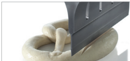
扭结面包的超声波切口
